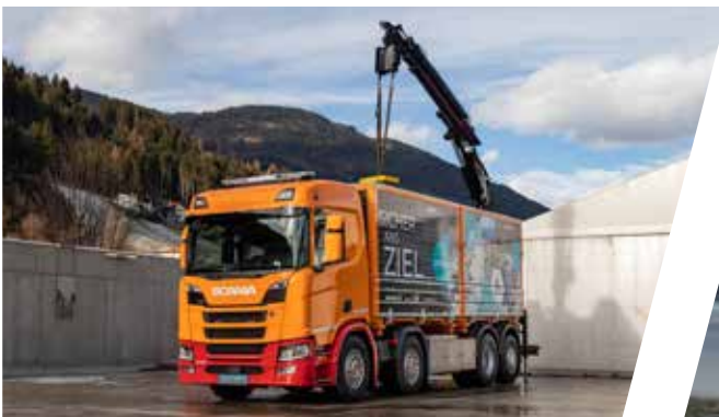
Sonderkipper für Altglastransport mit Kran Special Tipping Body for glass collection with crane
