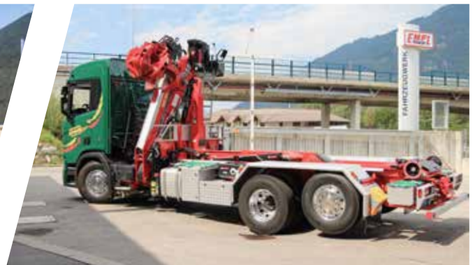
Hakengerät mit Schrotgreifer Hook Lift System with peel grab
