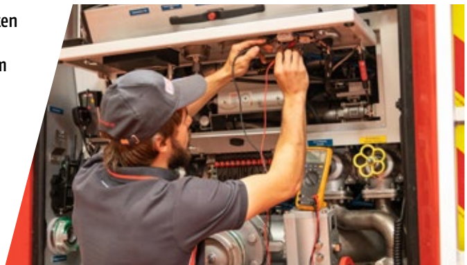
Fehlersuche am Bedienerpult der Einbaupumpe
