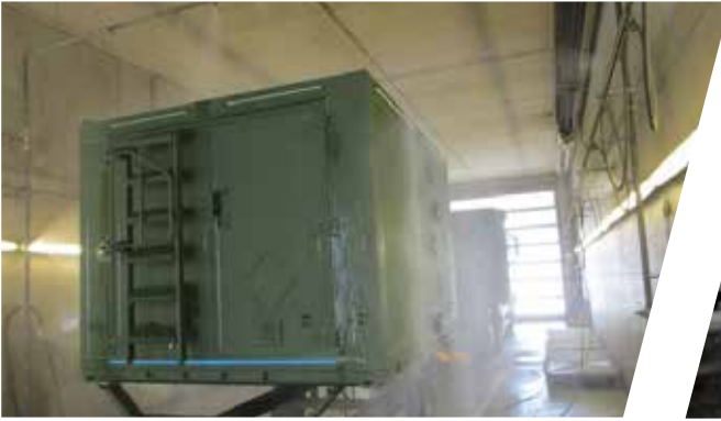
فحص الإحكام ضد التسرب/ اختبار المطر Leak Detection / Rain Test
