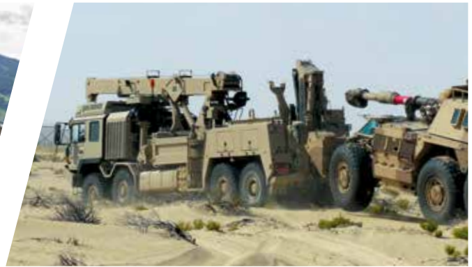
مركبة إنبال ثقيلة طراز EH/TC G6 Heavy Duty Recovery Vehicle EH/TC G6
