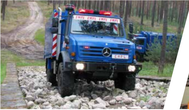
فحص المركبة عند السير على ركام الحجر السائب Verification of vehicle on loose gravel slope
