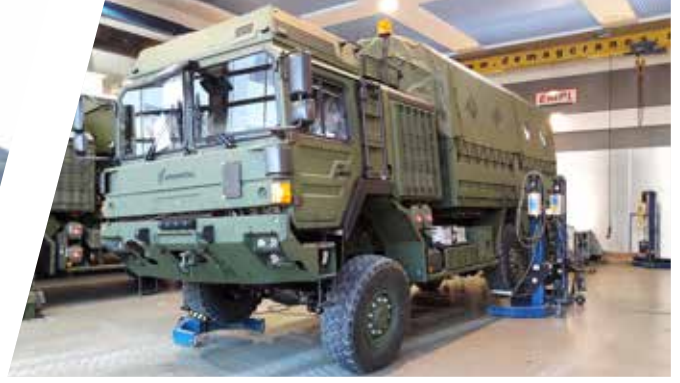
اللي القطري الاستاتيكي Static Torsion Test
