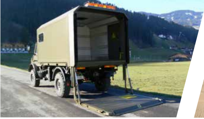
صندوق نقل بضائع قابل للتبديل برافعة في مؤخرة الشاحنة Interchangeable Van Type Body with Hydraulic Tailgate
