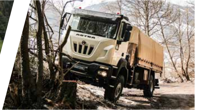
ناقلة قوات بآرائك جلوس جانبية قابلة للطي (24 شخصاً) Troop Carrier with foldable side seat benches (24 persons)
