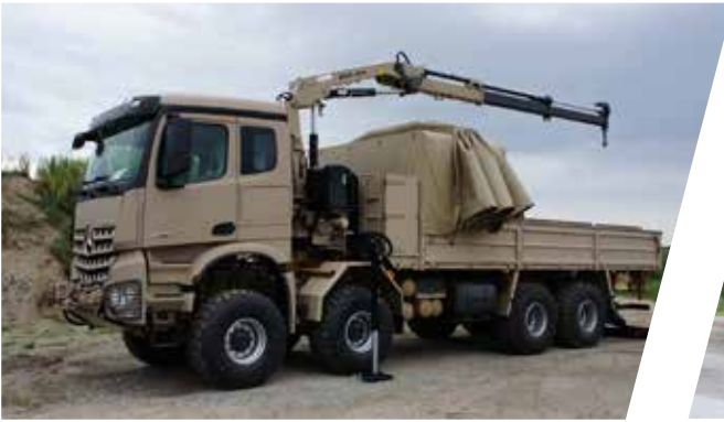
سطح تحميل بسقف منزلق ورافعة Cargo Body with Sliding Tarpaulin and Crane
