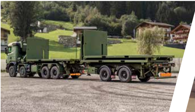
نظام حمل خطافي مع مقطورة مركزية المحور وأرفف حمل مسطحة HLS with Tandem Trailer and Flat Racks
