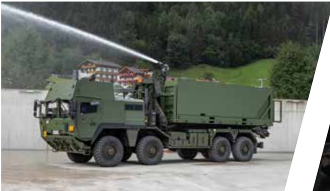
نظام حمل خطافي مع حاوية إطفاء Hook Loading System with Fire Fighting Container
