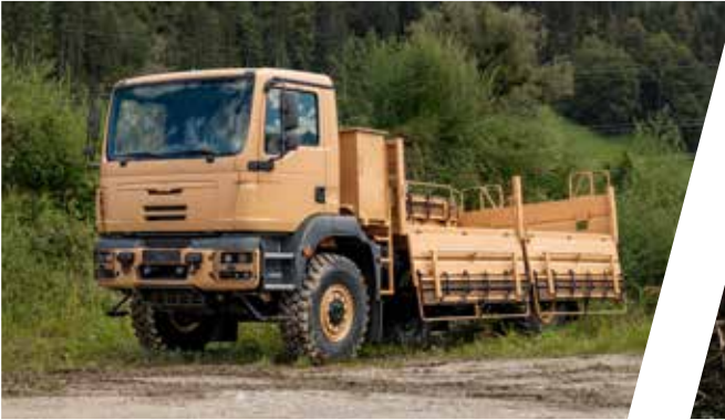
ناقلة قوات بآرائك جلوس جانبية قابلة للطي Troop Carrier with foldable side seat benches
