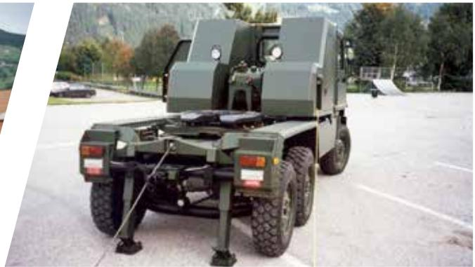
**Umbau auf Sattelzugmaschine mit Bergewinde**
