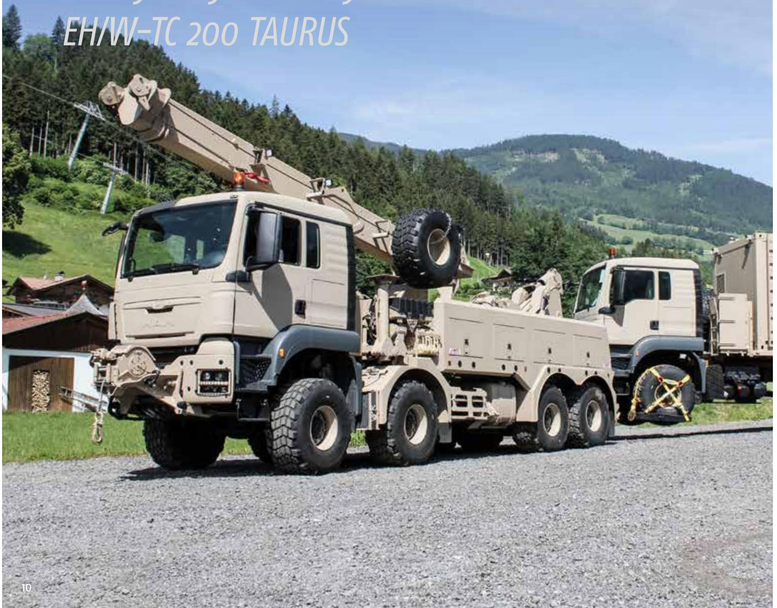
**A**lle Vorteile des BISON kombiniert mit leistungsstarkem, drehbarem Teleskop-Berge-Kran, welcher unabhängig vom Unterlift betrieben wird. Der EH/W-TC 200 TAURUS überzeugt durch seine Funktionalität.
