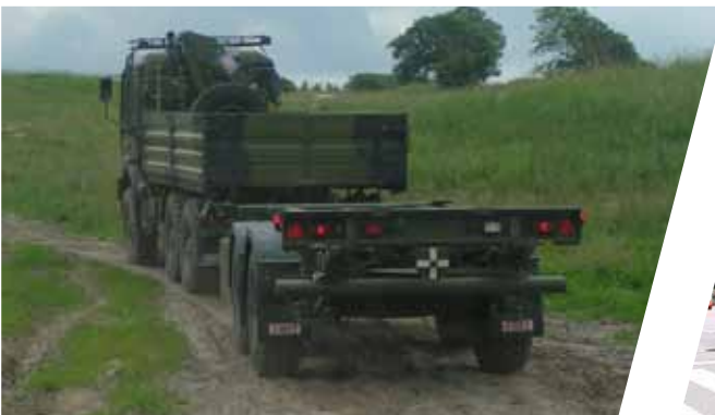
Hakenladesystem mit Flat Rack und Tandem-Schlitten-Anhänger Hook Loading System with Flat Rack and Turntable Trailer
