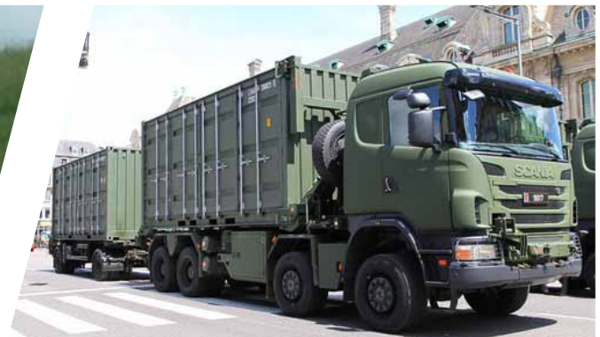
Hakenladesystem mit Flat Rack und Schlitteanhänger Hook Loading System with Flat Rack and Sliding Tray Trailer
