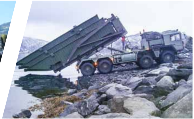
Hakenladesystem mit Flat Rack für Wasserung / Rückholung von Pontons Hook Loading System with Flat Rack for Launching / Recovering of Pontoons
