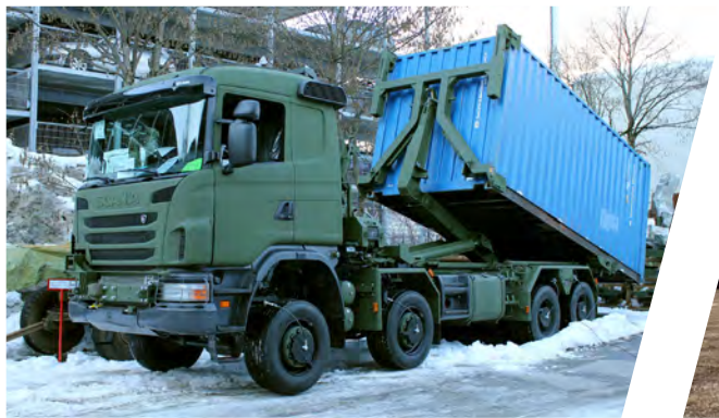
Sistema de manipulación de carga con unidad de manipulación de contenedores
