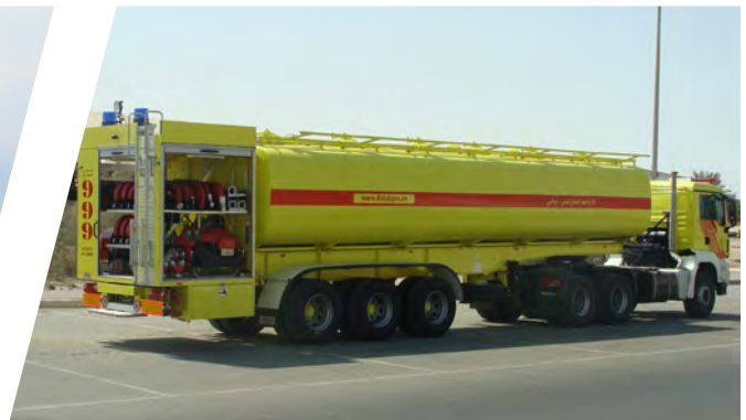
Semirremolque cisterna con depósito de agua de 40000 litros
