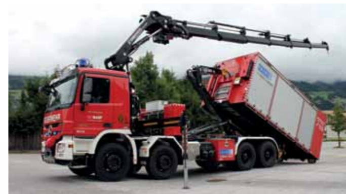
WLF-K, Wechselladefahrzeug mit Kran
