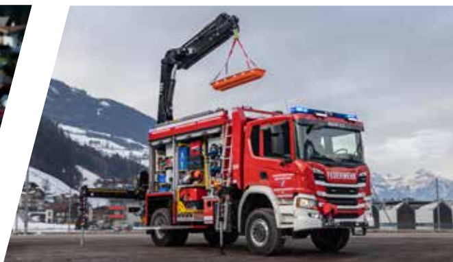
Véhicule de sauvetage lourd avec grue Vehículo de rescate pesado con grúa
