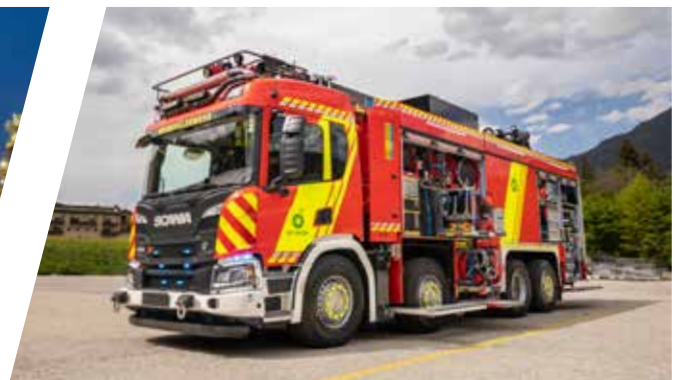
Camion anti-incendie universel avec bras d'extinction Scorpio Vehículo universal de lucha contra incendios con brazo extintor Scorpio
