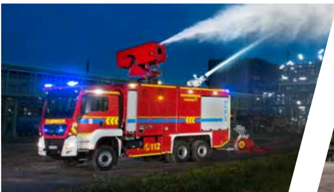
Camion anti-incendie universel avec turbine à hydro-jet Vehículo universal de lucha contra incendios con hidro-jet turbina
