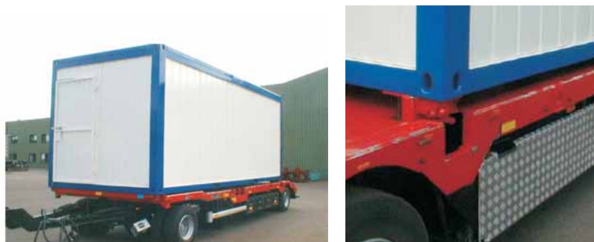
Sonderausführung mit versenkbarer ISO-Containeraufnahme
