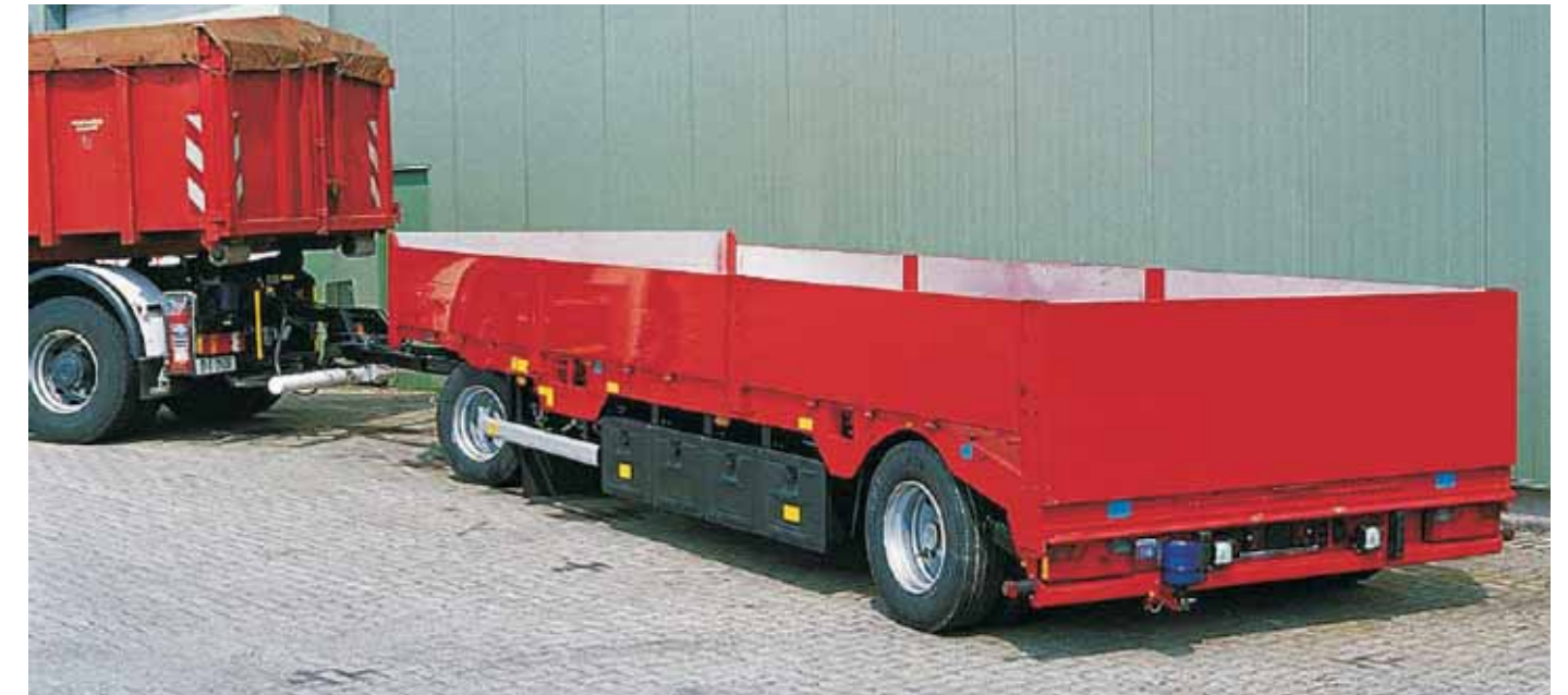
Sonderausführung mit abnehmbaren Bordwänden
