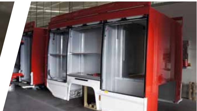
Aufbau aus kunststoffbeschichteten Aluminium Sandwich-Paneelen Body made of aluminium sandwich panels
