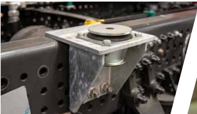
Lagerungskonsole Aufbau Supporting point for the body
