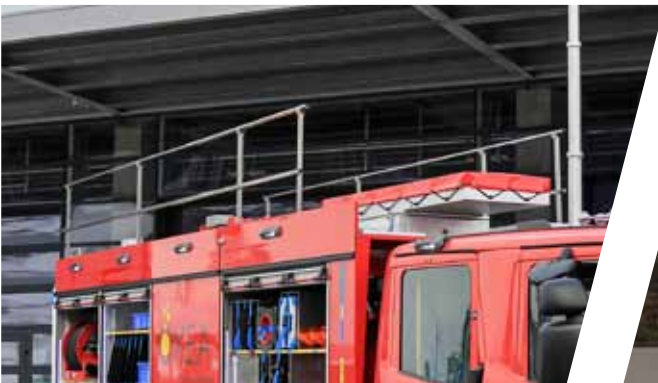
Dachgeländer Roof railing
