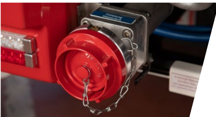
Tankfülleitung mit Belüftungsventil und Rückschlagklappe (DVGW)
