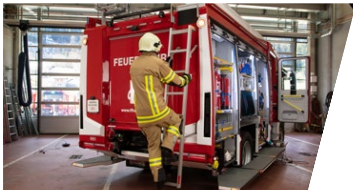
Selbstarretierende Heckaufstiegsleiter mit Schrägstellung
