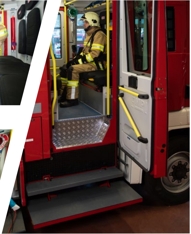
pneumatisch abklappbare Auftritte pneumatically folding access step
