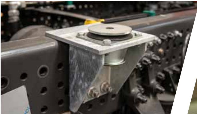
Lagerungskonsole Aufbau Supporting point for the body
