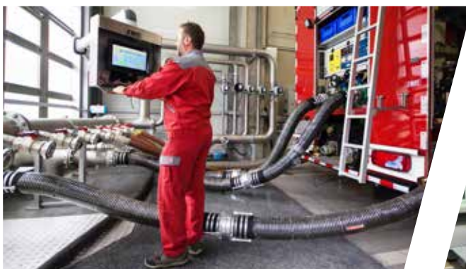
Pumpenprüfstand Pump test stand
