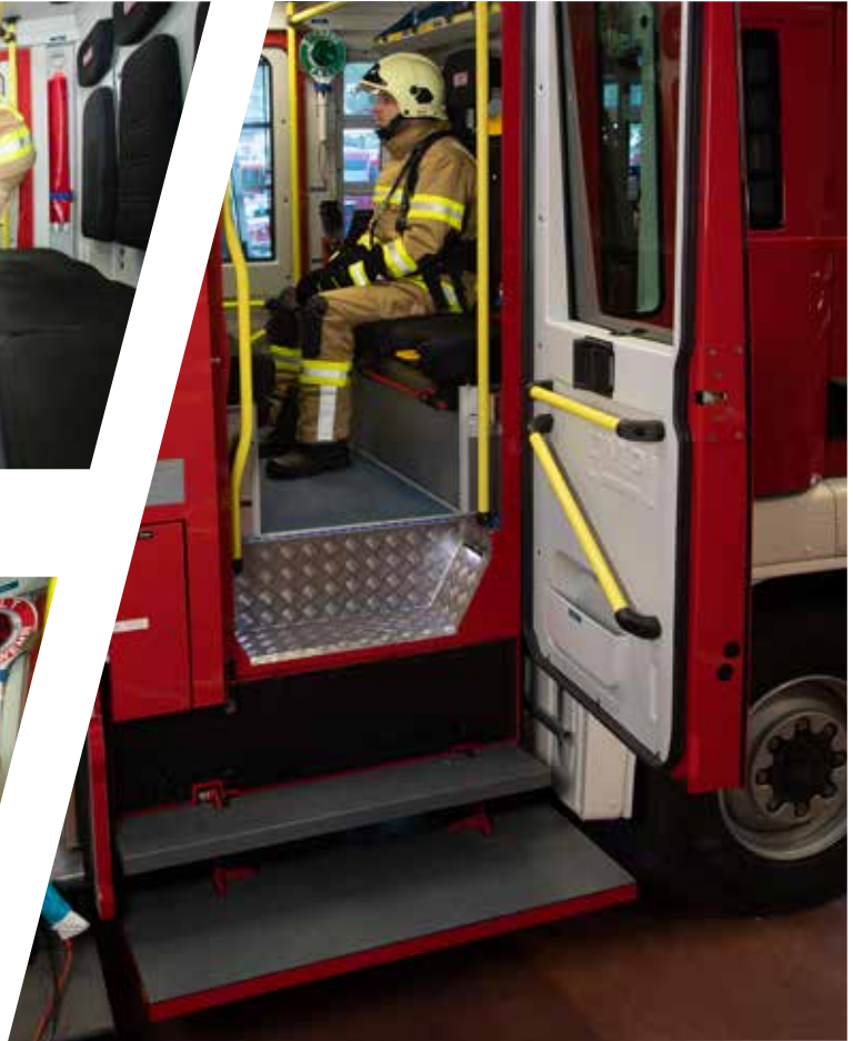
pneumatisch abklappbare Auftritte pneumatically folding access step
