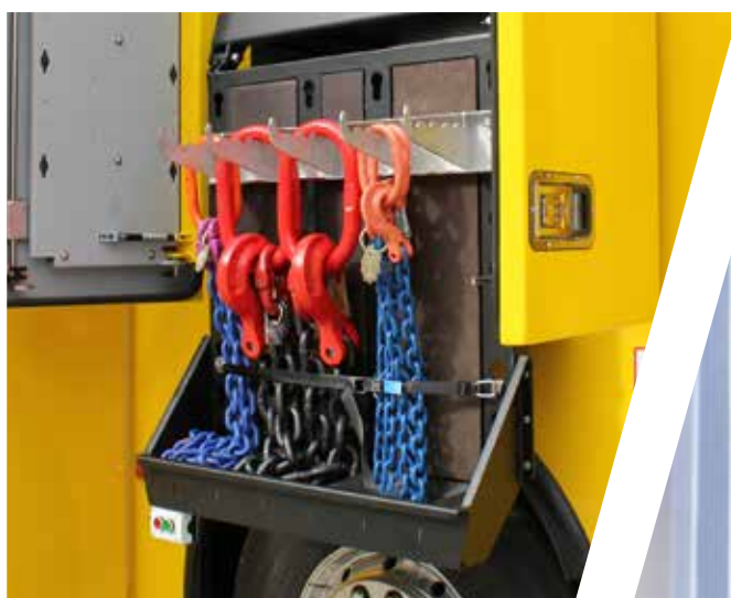
Paroi de fixation à abaissement hydraulique
