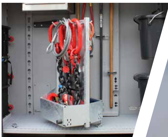
Paroi pivotante avec supports des deux côtés pour l'équipement
