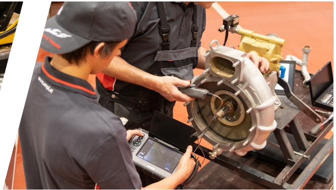
Inspektion einer Pumpe auf Beschädigungen mittels Kamera
