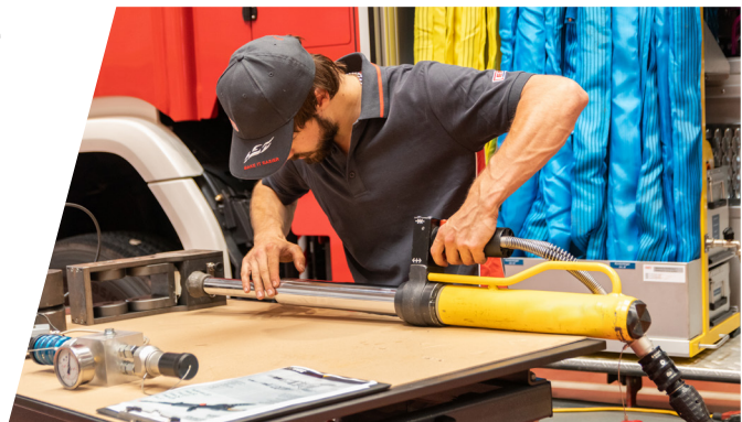
Überprüfung von einem hydraulischen Stempel
