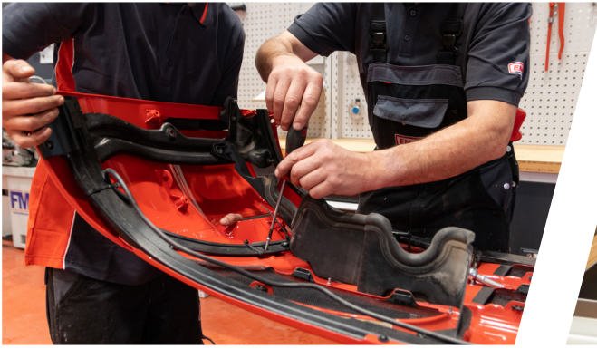
Vorbereitung zum Austausch von einem Karosserieteil
